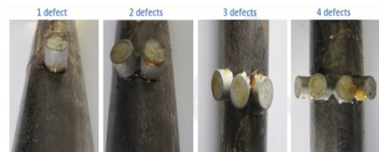
Figure 2: Défaut à extension circumférentielle, effectué en quatre étapes augmentant ainsi sa taille et modifiant sa géométrie
