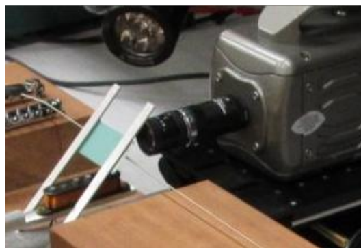
Figure 4: Mesure de vibrations de cordes à l'aide d'une caméra rapide
