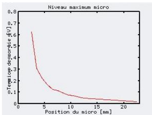
Figure 9: Niveau de sortie du pickup en fonction de sa distance par rapport à la corde
