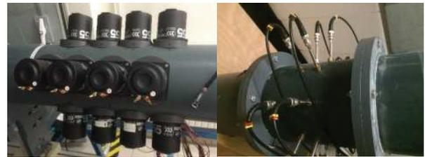
Figure 3: Le réseau de 16 haut-parleurs et l'antenne de 16 microphones.
