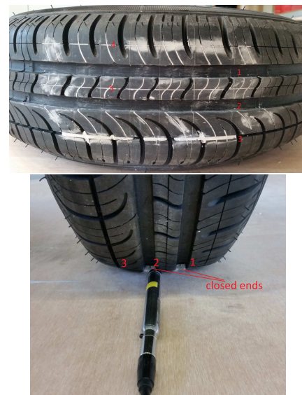
FIGURE 11 – (a) Zone de contact ; (b) Pneumatique avec un réseau fermé.
