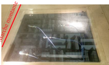
Figure 4 : mesures vibratoires par accéléromètres
