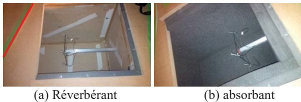
Figure 5 : mesure de la pression acoustique dans le caisson par microphones
