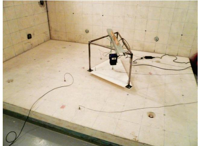
Figure 3 – Dispositif expérimental pour la mesure indirecte de la force bloquée équivalente
