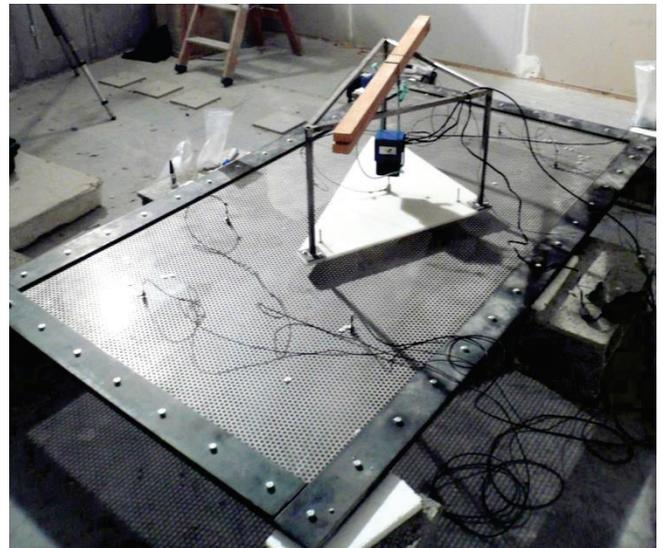
Figure 4 – Dispositif expérimental pour la mesure indirecte de la vitesse libre équivalente
