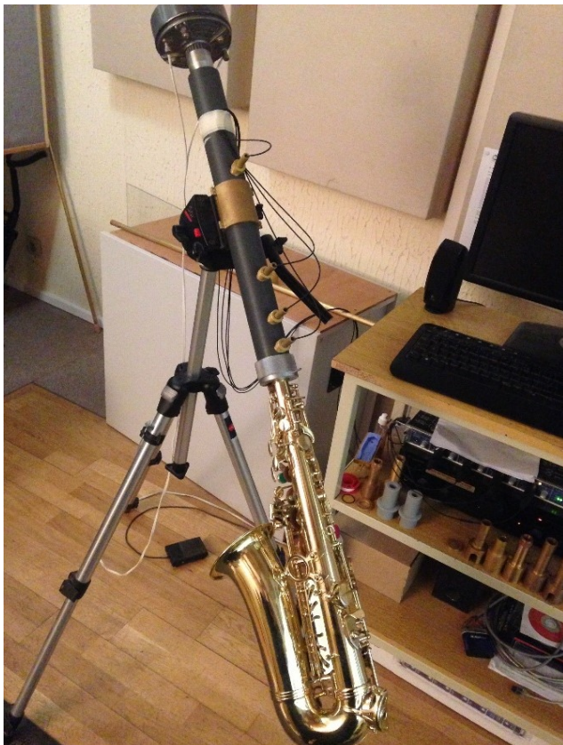
Figure 6 : Système complet de mesure du saxophone alto SIII sans bocal
