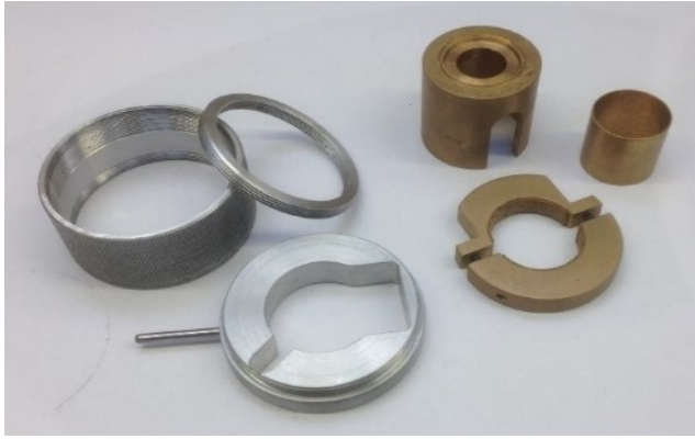
Figure 5 : Composants du système de fixation étanche du saxophone alto SIII sans bocal sur la tête de mesure
