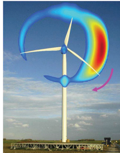
Figure 1 : Emission du bruit éolien mesuré par un réseau de microphones placé au sol [3]
