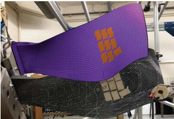
FIGURE 7 – Dispositif expérimental et modèle éléments finis
