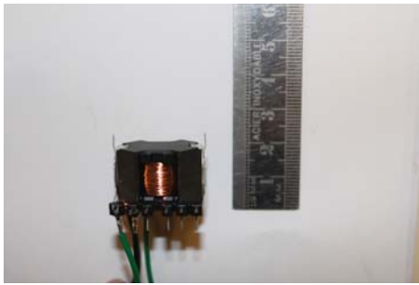
FIGURE 6 – Bobine du shunt résonant pour le second mode de flexion
