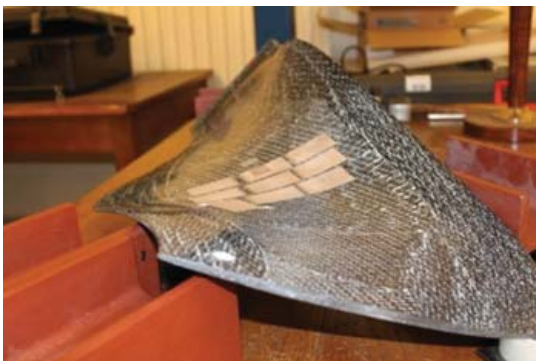
FIGURE 2 – Patches piézocéramiques sur l'intrados
