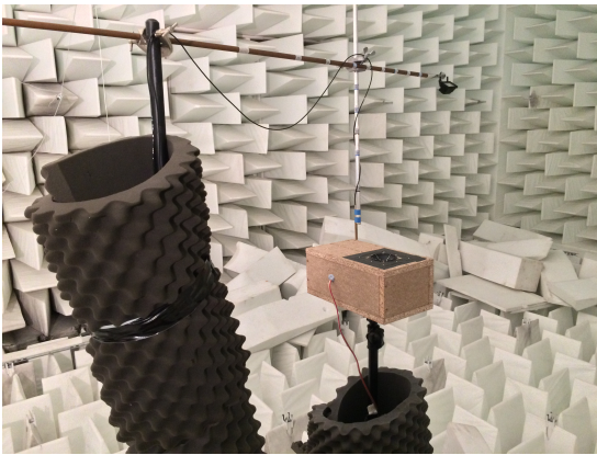
FIGURE 1 – Mesure de la pression rayonnée par le haut-parleur Visaton FRS 8 \Omega monté sur une enceinte close
