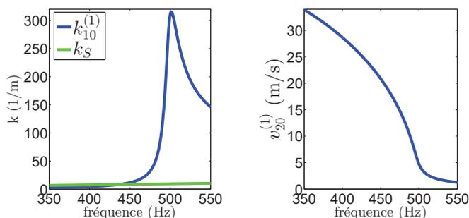
FIGURE 4 – a) Nombre d'onde  $k_{10}^{(1)}$  en fonction de la fréquence, en comparaison avec les  $k_S$  ;
