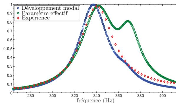
FIGURE 6 – Résultat expérimental du coefficient d'absorption en fonction de la fréquence comparé avec les résultats des simulations
