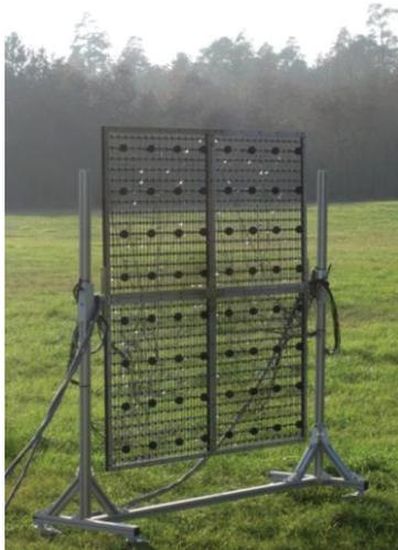
Fig. 2: Photographie de l'antenne acoustique sur le site de mesure, avec les 8x8 microphones.
