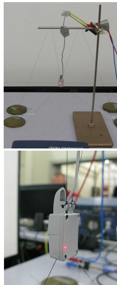
FIGURE 7 – Transducteur ostéophonique suspendu dans l'air pour mesures LDV.
