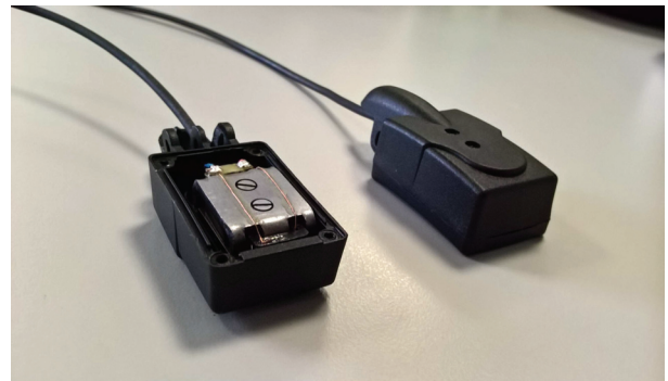
FIGURE 2 – Transducteur ostéophonique Elno ouvert et fermé.
