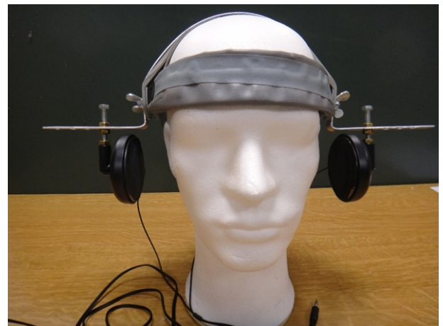
Figure 7 : Dispositif "casque audio ouvert" permettant d'émettre un son près de l'oreille sans l'isoler et qui suit les mouvements de la tête.
