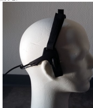
Figure 2 : Bandeau communicant placé sur une tête (fictive) avec deux écouteurs ostéophoniques.
