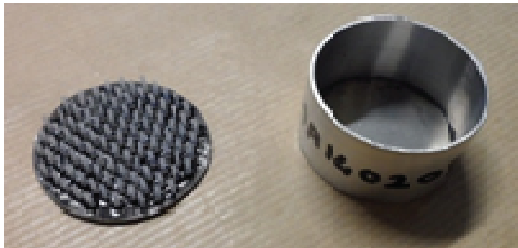
Figure 3 : Echantillon de type 2 de paroi avec tubes perforés (g) à placer au dessus de la cavité (d).
