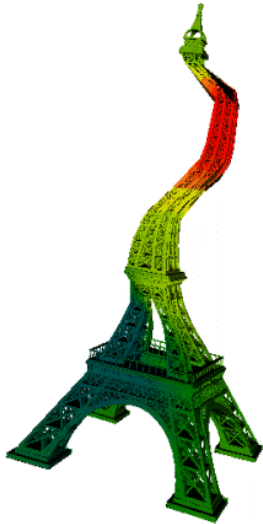
Figure 3: Exemple de déformé modale expérimentale.
