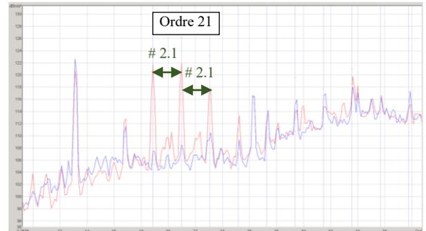
Figure 6: Spectre vibratoire en montée de régime du rapport 5.
