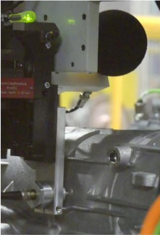
Figure 1: Emplacement des capteurs vibro-acoustique par rapport à la transmission en phase de test.
